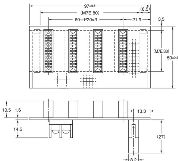
注1. 虚线表示安装M7E时的外形尺寸。
