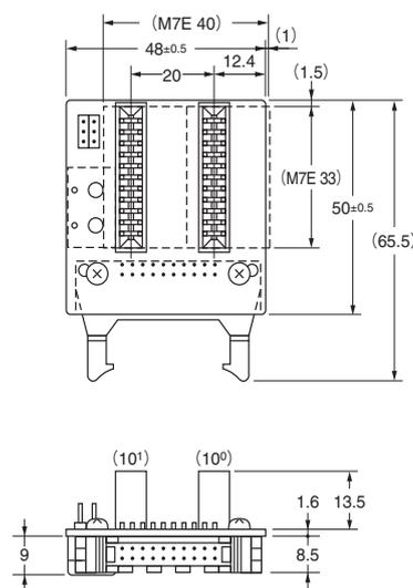
注1. 虚线表示安装M7E时的外形尺寸。
